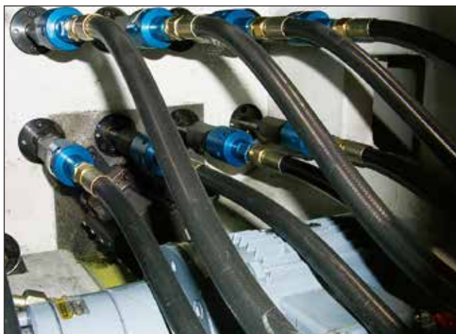
自動車用トランスファーラインに取付けられた1116ベアリング一体型ユニオン
