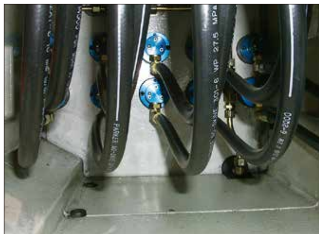
自動車用トランスファーラインに取付けられた1117ベアリングレス型ユニオン
