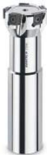
4枚刃縦置き型CN インサートの導入により、小型サイズエンドミルでも破損に対する耐性が最大限に高まりました。高い切込み量と高い一刃毎の送り速度の組み合わせが可能。ナローピッチの切刃配置は、鑄造加工に有利です。
