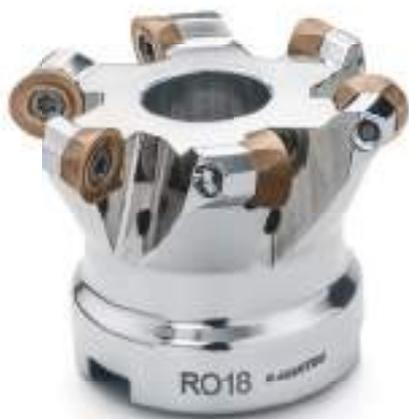
独自の回転防止機構付きRDGX-インサートはツール本体のシート座面に最適に固定されます。軸方向および径方向のすくい角により、「ソフト」なカットが保証されます。
