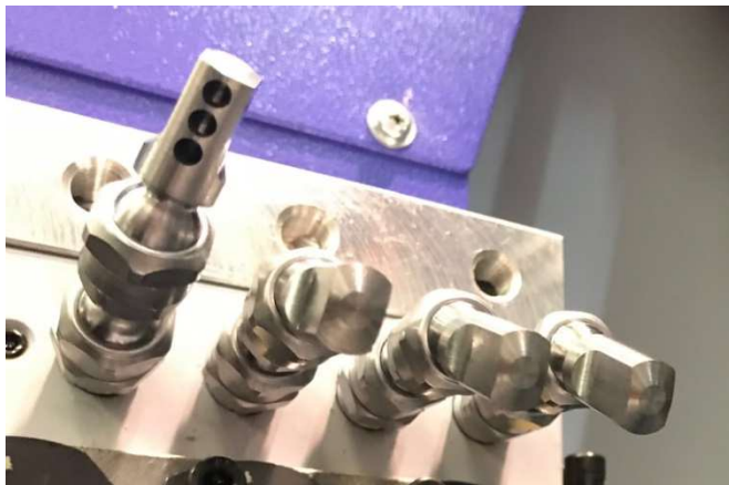
ツールの後方部を冷却する HECTO システム
