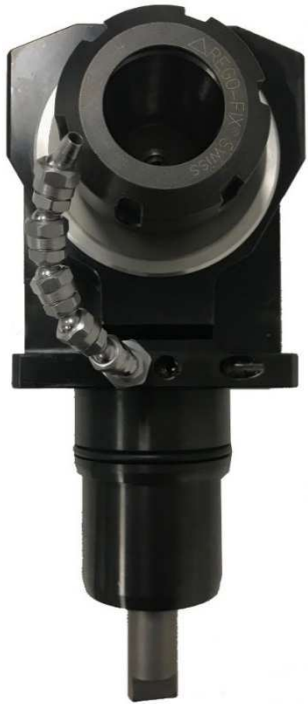
ロータリーツールホルダーに取り付けた DECA システム ストレートノズル ID:3mm & L:10mm
