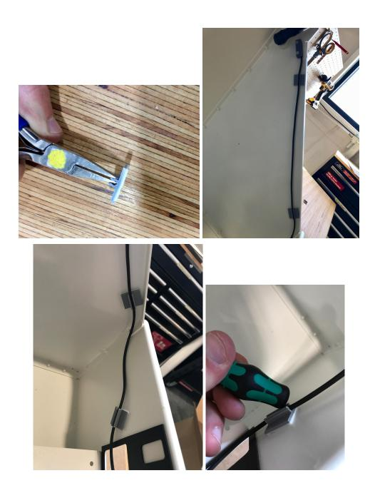
5) 安全スイッチを本機のサイドカバープレートに差し込みます。
