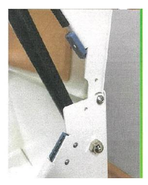
4) ワイヤークリップの取り付け ワイヤークリップをペンチなどで広げます。下図は推奨の取り付け位置です。 ドライバーなどの先端で、ワイヤーをワイヤークリップの間に押し込んでください。
