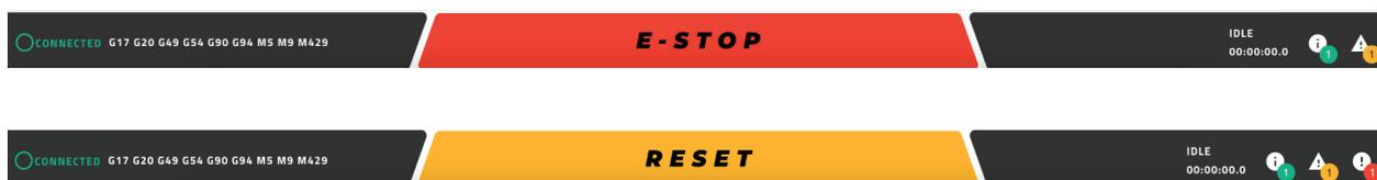
ステータスバーの左端は接続状態を表します。ここでは、機械との接続が確立されているかどうかを確認することができます。接続されている場合は緑の文字で「Connected」と表示され、切断されている場合は黄色の文字で「Disconnected」と表示されます。
