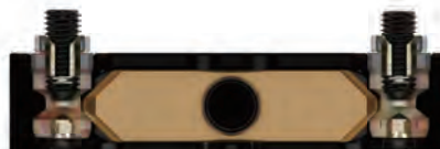
プスタッドボルト引込みイメージ
