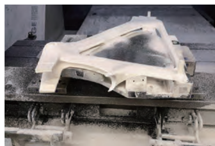
軟質材の非変形クランプ例
