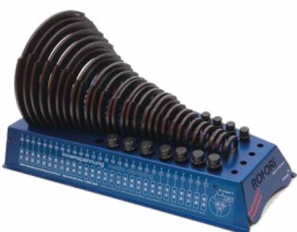
Die RotoRi Ausdrehringe aus hochfestem Spezialstahl haben je 4 Kurvensegmente, 4x90°, wodurch nur soviel Material wie nötig aus der Backe ausgedreht wird. Alle unsere RotoRi Premiumsets werden mit den patentierten RotoFix Spannbolzen ausgeliefert. Die Sets bestehen je nach Größe aus 13 - 29 Ringen, inkl. Ständer.
