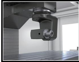
B軸方向は±120°、C軸方向は±245°の傾斜角度をもつため、ワークに対して多様なアプローチが可能。
