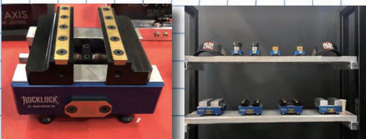
5thAXIS社は、新製品となる自動化向けトップツーリングをフルラインナップで展示。ロボットでの搬送の際に課題となる治具の重量の軽量化によって解決。
